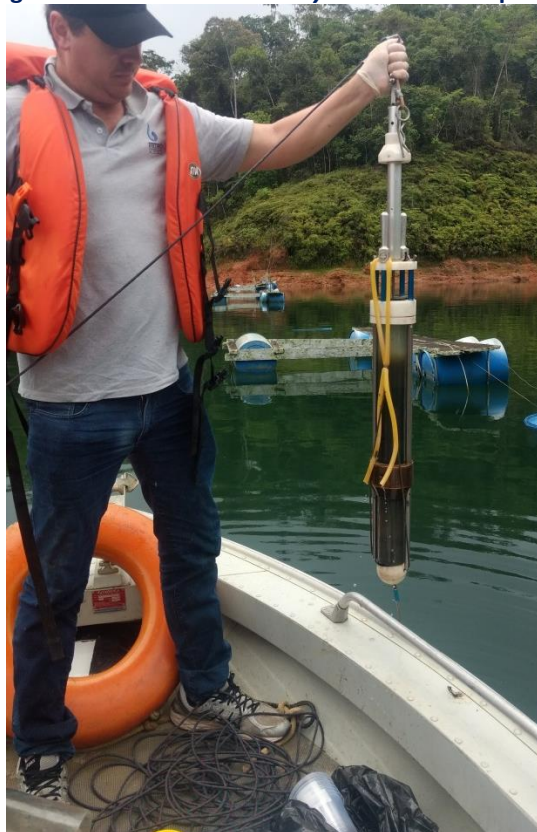
Figura 6 – Amostrador Gravity Corer utilizado para amostragem de sedimentos.
