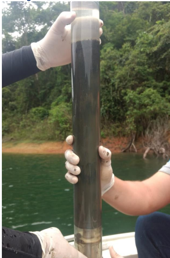
Figura 6 – Amostrador Gravity Corer utilizado para amostragem de sedimentos.
