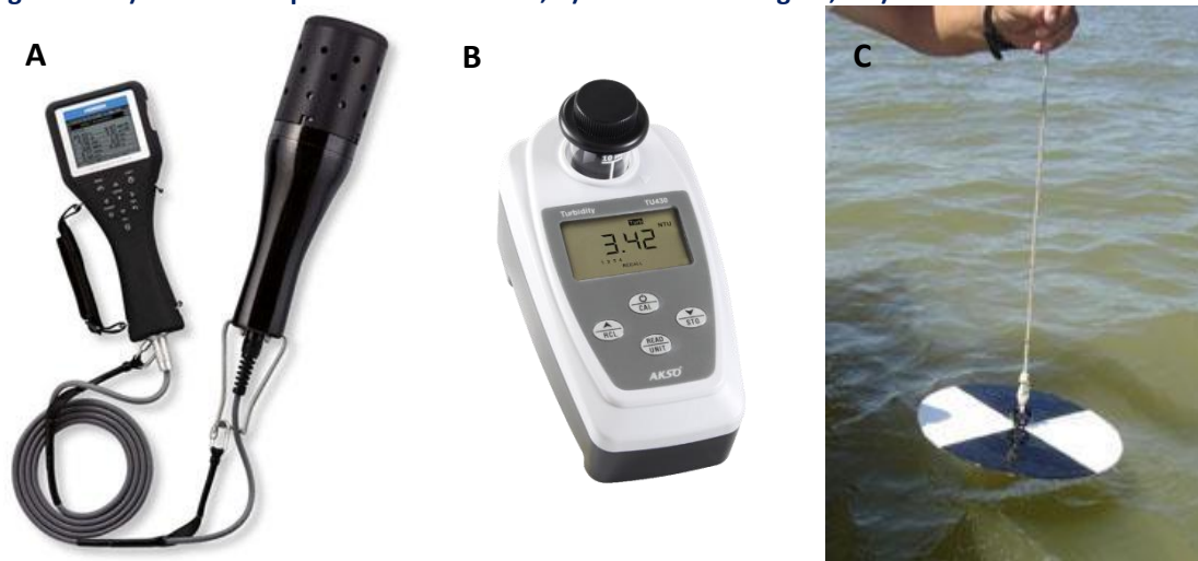
Figura 5 – A) Sonda multiparamétrica HORIBA; B) Turbidímetro digital; e C) Disco de secchi.
